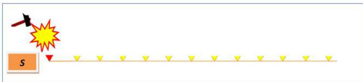
Figura 4 - Stendimento sismico per i primi 12 geofoni, rappresentati in giallo e posti a distanza costante di 2.0 m. A sinistra del trigger è posta la massa battente che costituisce la sorgente di energizzazione; a destra è collocato il sismografo per la registrazione dei segnali sismici.
