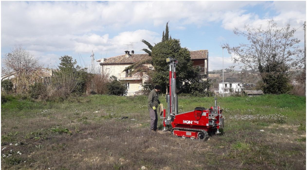
Figura 6 - Ubicazione della prova penetrometrica dinamica super pesante (DPSH, SCPT) P4
