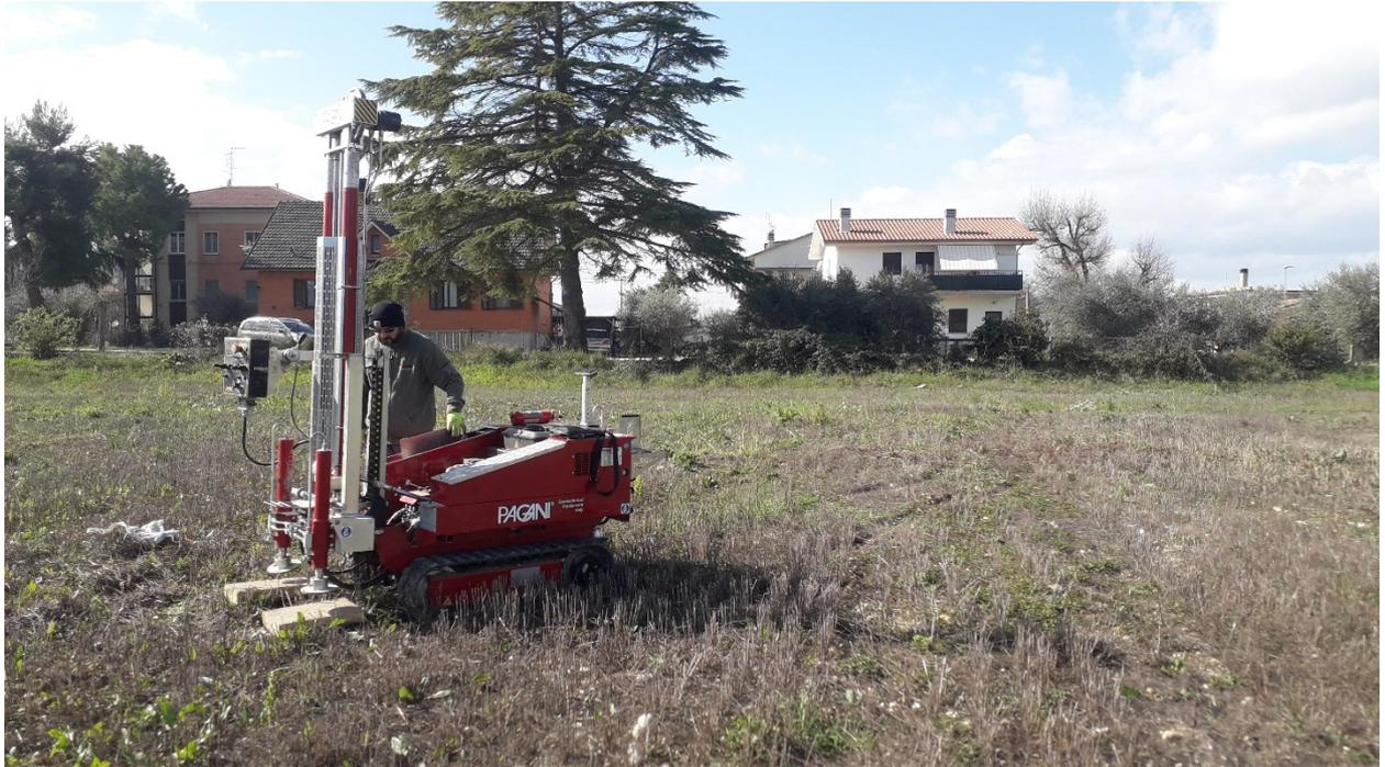
Figura 5 - Ubicazione della prova penetrometrica dinamica super pesante (DPSH, SCPT) P3
