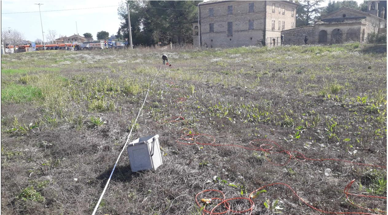
Figura 6 - Stendimento sismico lineare realizzato in sito.
