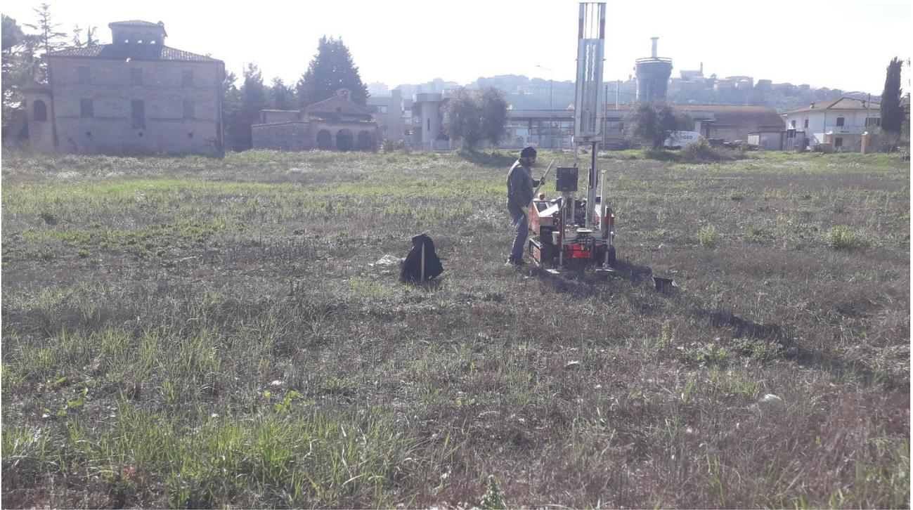
Figura 8 - Ubicazione della prova penetrometrica dinamica super pesante (DPSH, SCPT) P5
